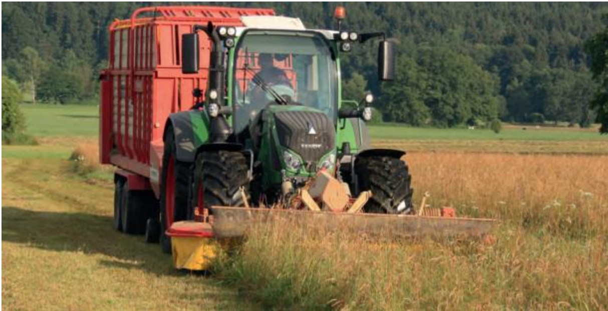
Abbildung 1: Mähen und Aufladen als kombiniertes System (Lfl, 2018)
